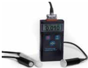
Рис. 7. Вихрострумний товщиномір Sedge-42
