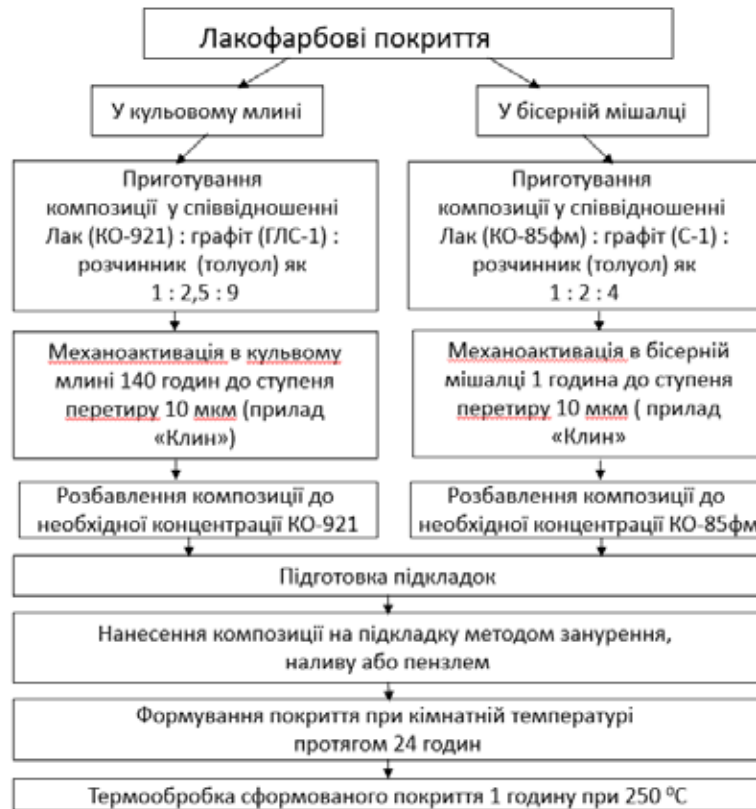
Рис. 1. Технологічна схема виготовлення композиційних матеріалів у вигляді покриттів
