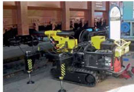
Рис. 5. Мобільна установка правки та заміни люків напіввагонів
