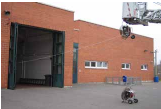
Рис. 6. Приклад паралельно вертикального розташування переносних засобів димо- та тепловидалення
